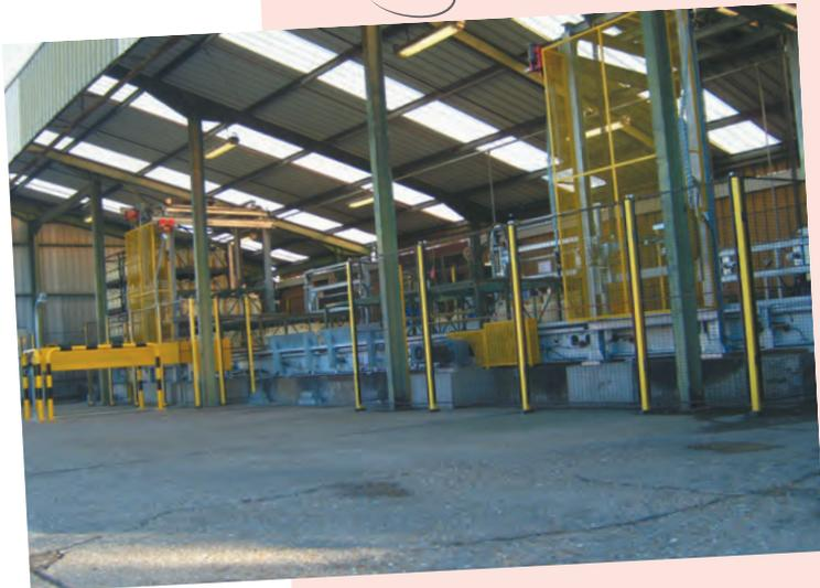
En 2012, Sigalnor a réalisé, dans le cadre de ses investissements, le remplacement de l'installation de palettisation de sa ligne principale d'emplissage de bouteilles.
